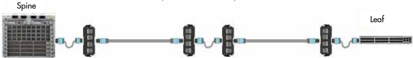
Figure 7. Leaf-spine avec une liaison de fibres parallèles et un DA intermédiaire
