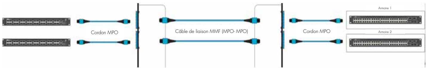
Figure 3. Connectivité d'un switch 40G avec le 40GBASE-SR4 (remarque : pour des raisons de simplicité, les broches ne sont pas indiquées)
