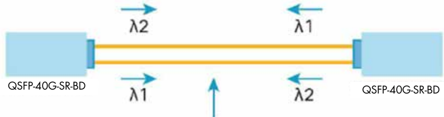
Fibre multimode duplex avec des connecteurs LC aux deux extrémités
