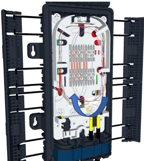
Afin de respecter le rayon de courbure, il est impératif de respecter l'ordre de mise en place des fibres dans le support d'épissures.
