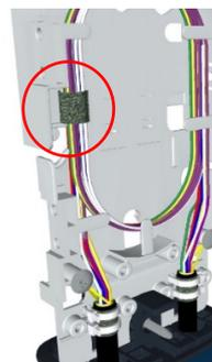
Placer une bande autocollante pour maintenir les  $\mu$ -modules en place.
