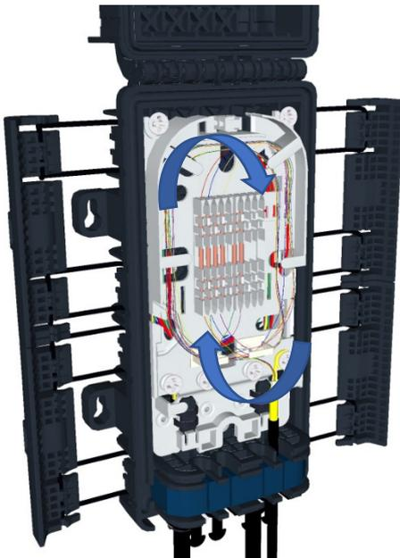
Afin de respecter le rayon de courbure, il est impératif de respecter l'ordre de mise en place des fibres dans le support d'épissures.
