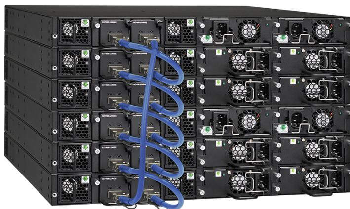
Figure 1 : Les commutateur RUCKUS ICX peuvent être empilés à l'aide de ports et fibres optiques SFP+ ou QSFP+ standard pour créer un appareil logique unique sur des distances atteignant 10 km.
